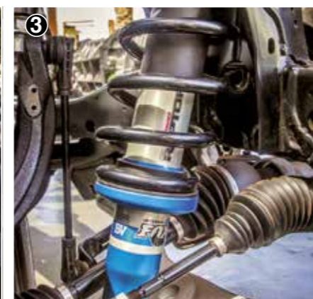
1 El cambio automático de diez velocidades cuenta con levas en el volante. 2 Los asientos delanteros deportivos son de diseño exclusivo para este modelo. 3 Los amortiguadores delanteros y traseros están firmados por el especialista en competición Fox Racing. 4 La caja de carga incluye una cubierta enrollable y un revestimiento plástico. 5 El Raptor incorpora un programa con seis escenarios de conducción predefinidos: Auto, Sport, Hierba/grava/nieve, Barro/arena, Rocas y Baja. Este último toma su nombre de la competición Baja 1.000 y está orientado a la circulación a gran velocidad por pistas.
